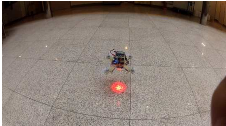
그림 2 제안된 방법으로 정지비행 중인 마이크로 쿼드로터 (동영상 링크 : http://goo.gl/Jpyze )
