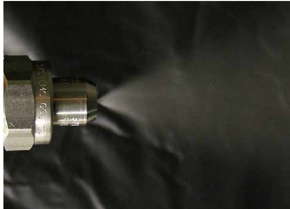
그림 3.1 인젝터 분사실험 모습
